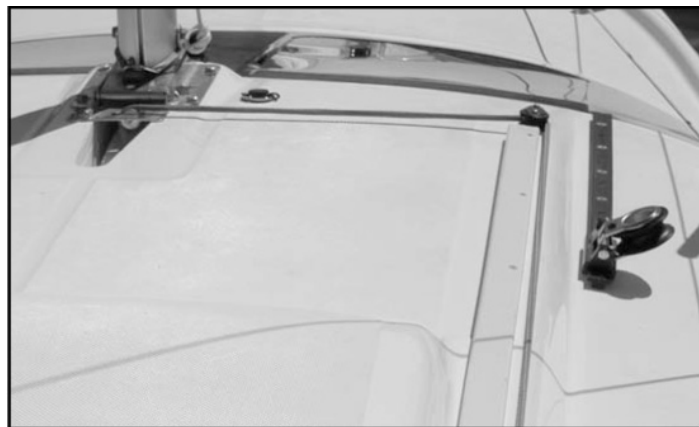
Проводка линия для подъема шверта
